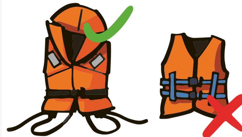
Il giubbotto di salvataggio è dotato di collo, così da offrire sicurezza anche in stato di incoscienza, nonché di nastri cosciali che impediscano di scivolare verso l'alto. In barca va sempre indossato.
